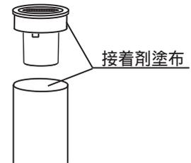
通常排水 (常温)でVU配管で施工をする場合は、VUスリーブにも耐熱塩ビ用接着剤を塗布し接続してください。
